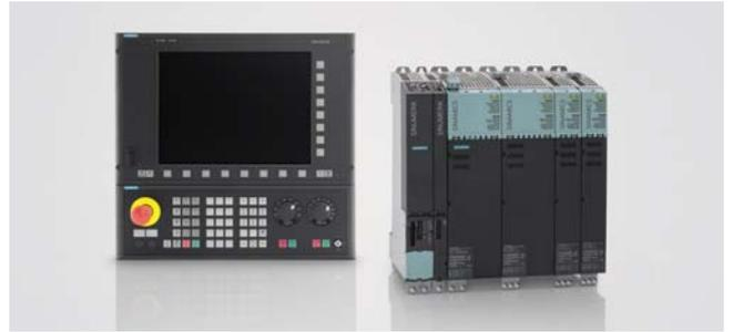
Приводы SINAMICS S120 имеют модульную конструкцию и находят применение для решения комплексных приводных задач в различных секторах промышленного производства. Все компоненты SINUMERIK 840D sl и SINAMICS S120, включая двигатели и датчики, объединяются в единую систему через последовательный интерфейс DRIVE-CLiQ.
