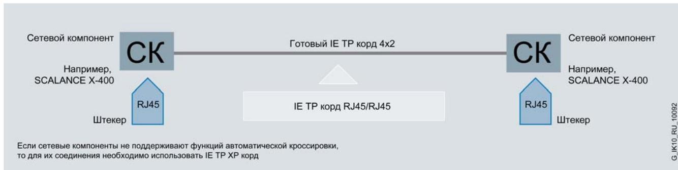
Использование IE TP корда RJ45/RJ45 4x2 для непосредственного соединения сетевых компонентов со скоростью обмена данными 10/ 100 1000 Мбит/с
