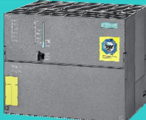
Микропроцессор Intel Core Duo 1,2 ГГц; оперативная память с емкостью 1 Гбайт; Flash диск емкостью 2 Гбайт; операционная система Windows XP Embedded + SIMATIC WinAC RTX 2009
